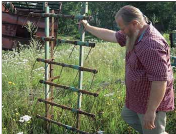
Борона пружинна власного виробництва. Фото О. Дона https://agroportal.ua/
