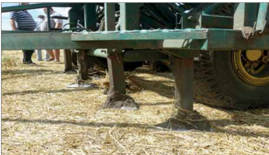
Висівний сошник сівалки власного виробництва фермера О. Дона. Фото М. Бикова, 2017 р.
