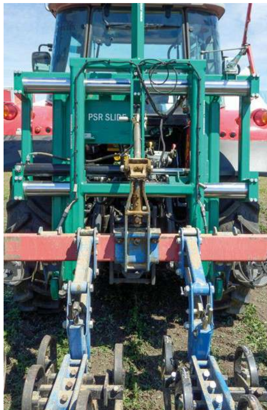
Ця лінійна пересувна рама може управлятися RTK або ультразвуковим сенсором.
