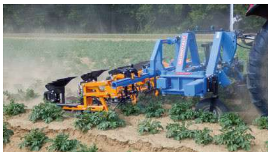
За допомогою підгортальної техніки здійснюється засипання бур'янів й одночасно формуються великі й стійкі гребені.
