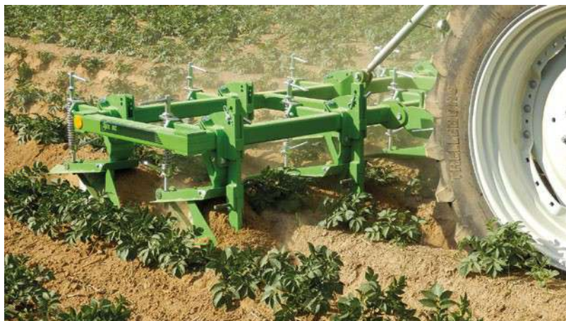
За допомогою підгортальної техніки здійснюється засипання бур'янів й одночасно формуються великі й стійкі гребені.
