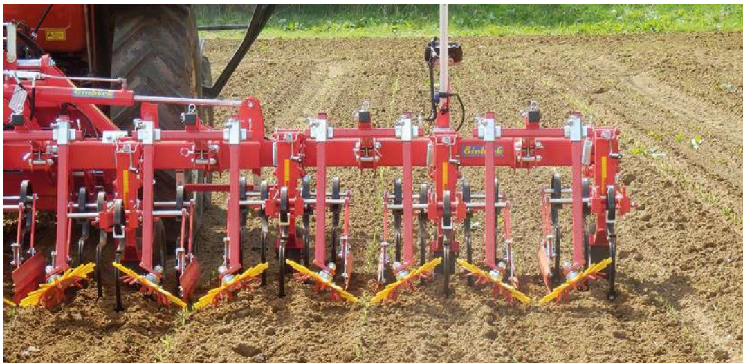
Використання ріжучої борони із пластинами для захисту рослин на ранній стадії обробітку
