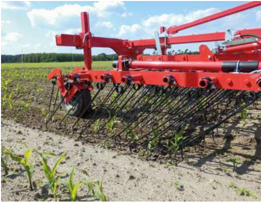
Штригельна борона з прямим пружинним регулюванням зубів
