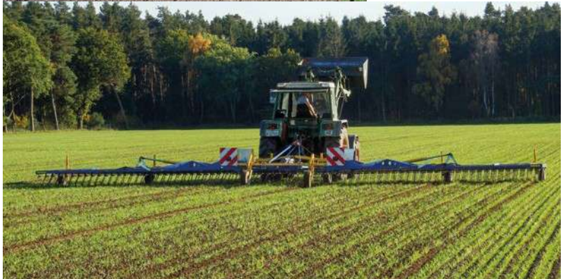
Штригельна борона з прямим пружинним регулюванням зубів
