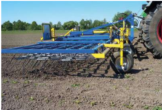
Штригельна борона з опосередкованим пружинним регулюванням зубів за допомогою тягових чи натискних пружин (цукровий буряк, ВВСН 12)
