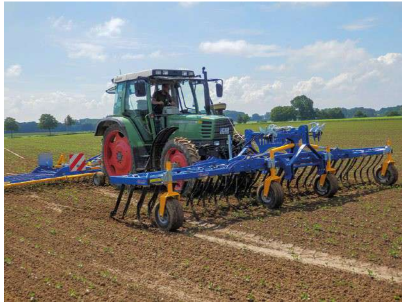
Ріжучі плоскі борони із автоматичним проходженням наміченою контрольною смугою є порівняно більш вигідною за ціною альтернативою.
